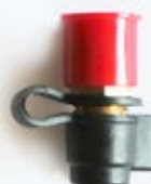
Válvula de Seguridad Toma Presión Aplicación: Atego 1016 Código: II15115
