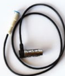
Sensor ABS Trasero Aplicación: Mercedes Código: K144129
